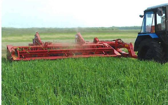
**КОСИЛКА-ИЗМЕЛЬЧИТЕЛЬ НАВЕСНАЯ ПАЛЕССЕ СН15****MOUNTED ROTATING MOWER-SHREDDER PALESSE CH15**
