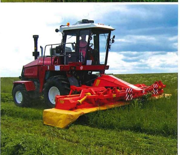
**КОМПЛЕКС ДЛЯ СКАШИВАНИЯ ТРАВ - ЭНЕРГОСРЕДСТВО С КОСИЛКОЙ-ПЛЮЩИЛКОЙ РОТАЦИОННОЙ НАВЕСНОЙ ДВУХСЕКЦИОННОЙ ПАЛЕССЕ CH60
