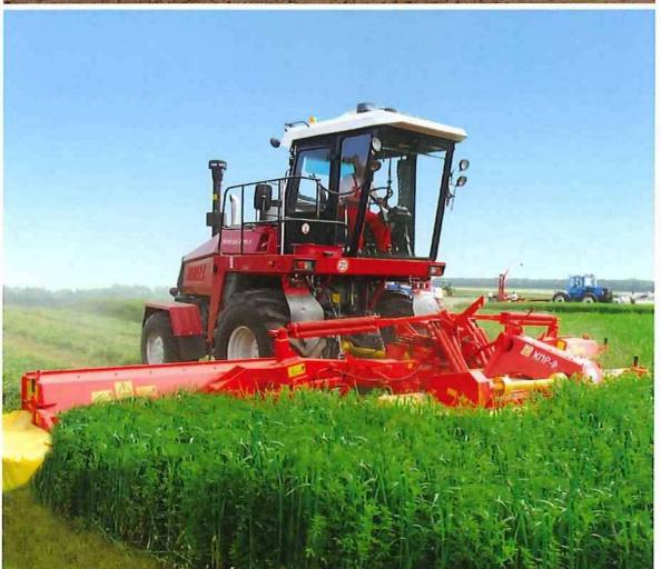
**КОМПЛЕКС ДЛЯ СКАШИВАНИЯ ТРАВ - ЭНЕРГОСРЕДСТВО С КОСИЛКОЙ-ПЛЮЩИЛКОЙ РОТАЦИОННОЙ ТРЕХСЕКЦИОННОЙ НАВЕСНОЙ ПАЛЕССЕ CH90
